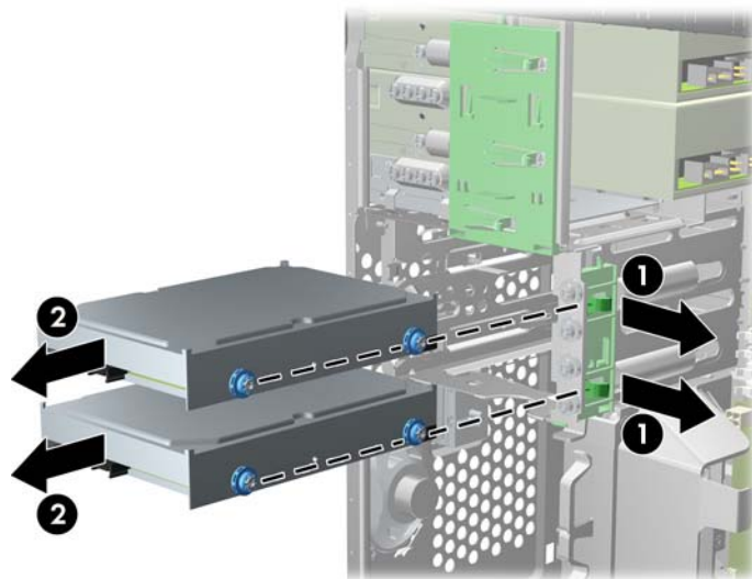
Figura 3-26 Extracción de una unidad de disco duro
