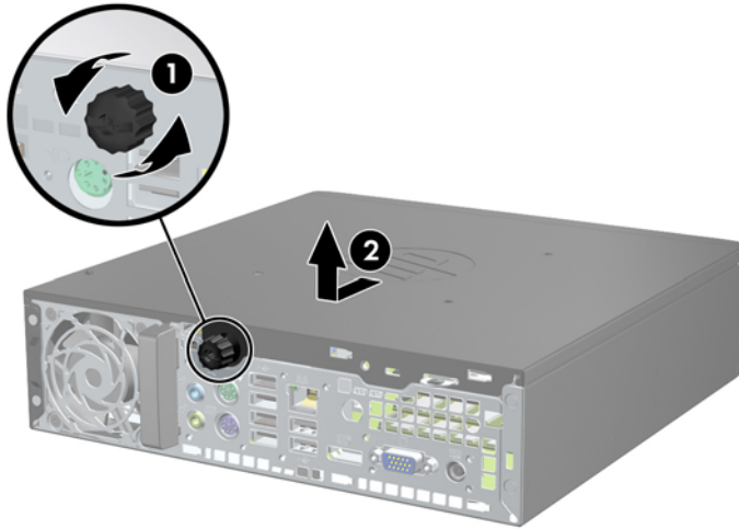
Figura 5-2 Extracción del panel de acceso del equipo
