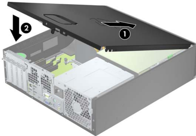
Figura 4-2 Reinstalación del panel de acceso del equipo
