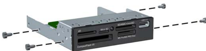
Figura 4-30 Instalación de tornillos guía (se muestra un lector de tarjetas multimedia)
