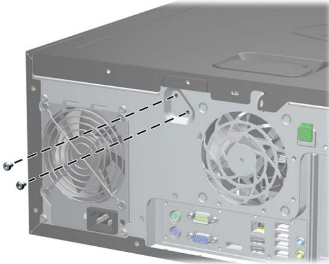
Figura C-2 Extracción de los tornillos del bloqueo inteligente de cubierta de la Microtorre
