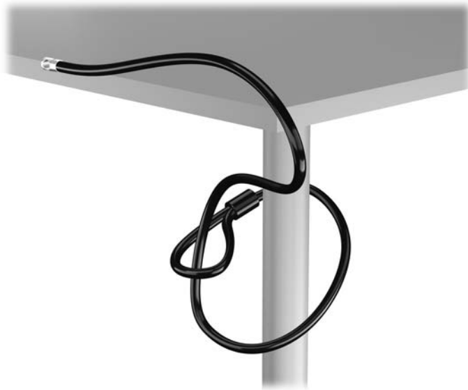
Figura 4-43 Acoplado del cable a un objeto fijo
