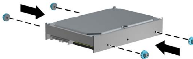
Figura 4-38 Instalación de los tornillos guía en la unidad de disco duro
