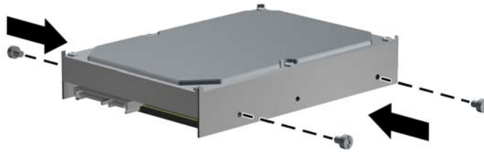
Figura 2-29 Instalación de tornillos guía estándar
