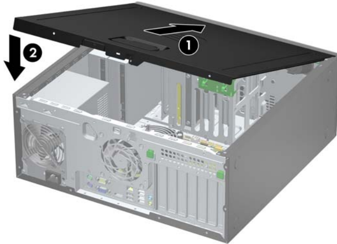
Figura 2-2 Reinstalación del panel de acceso del equipo
