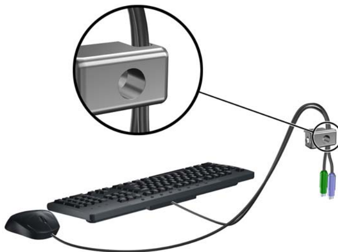
Figura 5-31 Enroscado de los cables del teclado y del mouse
