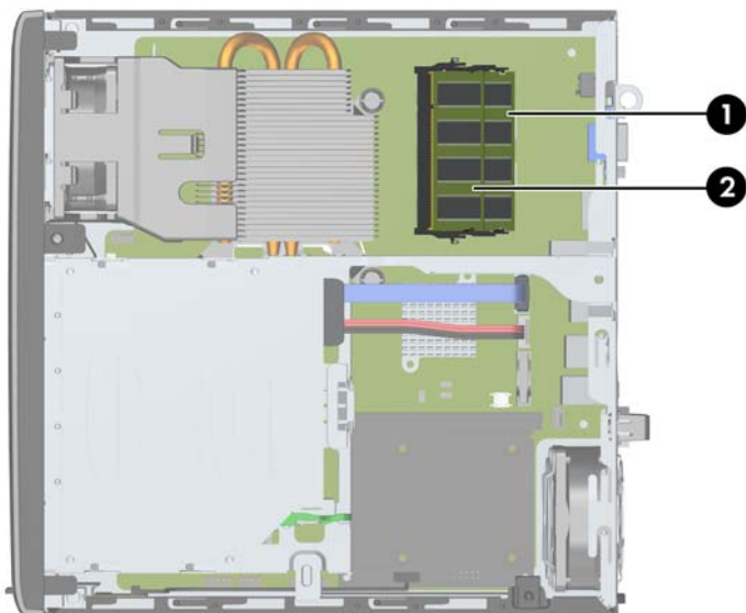
Figura 5-9 Ubicaciones de los sockets SODIMM
