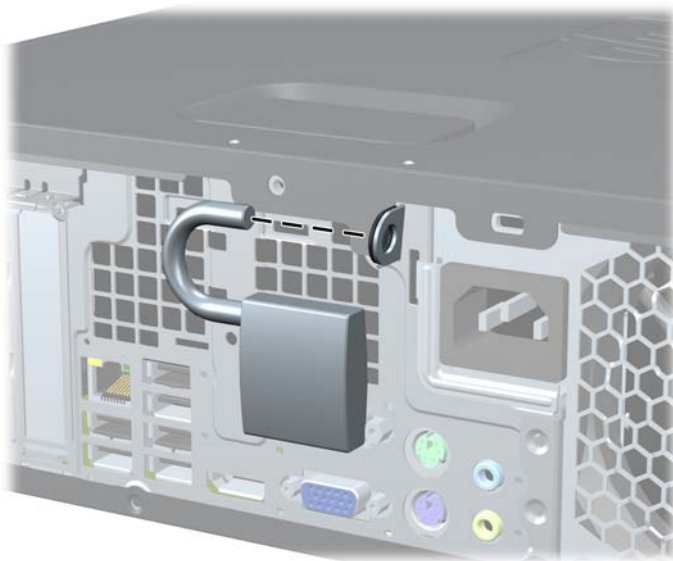
Figura 4-42 Instalación de un candado
