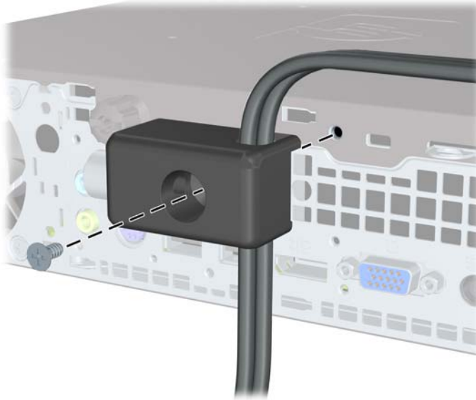
Figura 5-32 Acoplado del bloqueo al chasis
