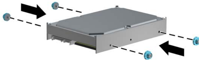
Figura 3-27 Instalación de los tornillos guía de montaje en una unidad de 3,5 pulgadas
