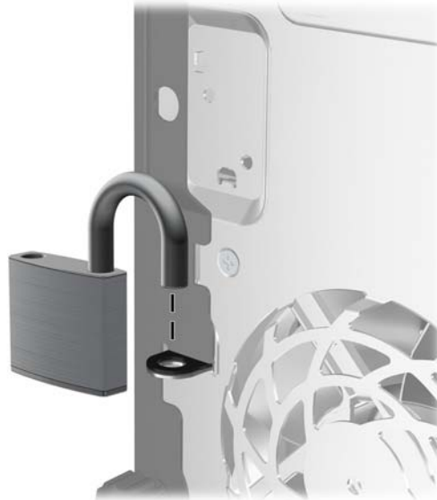
Figura 3-34 Instalación de un candado
