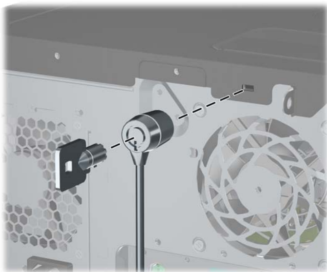
Figura 2-39 Instalación de un bloqueo de cable
