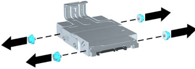
Figura 5-17 Extracción de los tornillos guía
