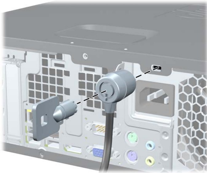
Figura 4-41 Instalación de un bloqueo de cable
