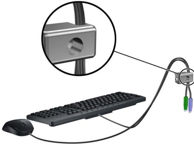
Figura 4-47 Enroscado de los cables del teclado y del mouse
