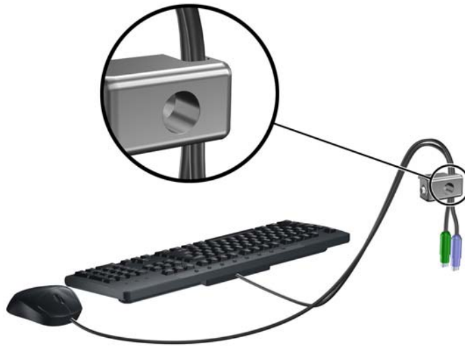
Figura 3-39 Enroscado de los cables del teclado y del mouse
