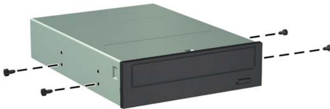
Figura 4-23 Instalación de tornillos guía en la unidad óptica (2 de 2)
