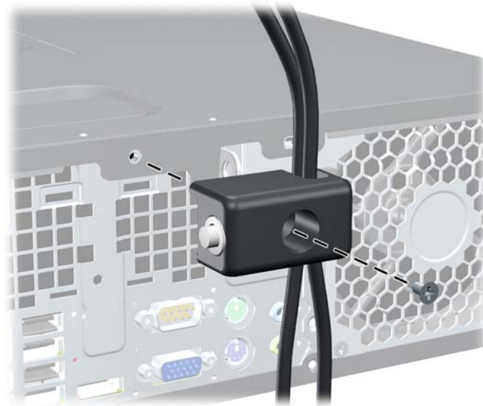
Figura 4-48 Acoplado del bloqueo al chasis
