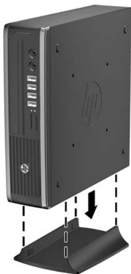
Figura 5-7 Colocación del equipo en la base
