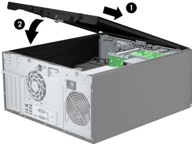
Figura 3-2 Reinstalación del panel de acceso del equipo
