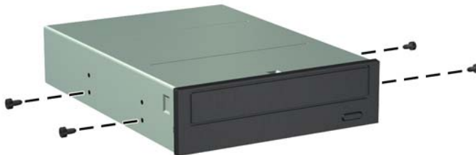
Figura 3-21 Instalación de tornillos guía (se muestra una unidad óptica)
