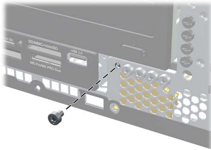
Figura 4-51 Extracción del tornillo de seguridad del panel frontal
