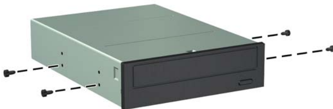
Figura 4-23 Instalación de tornillos guía en la unidad óptica (2 de 2)
